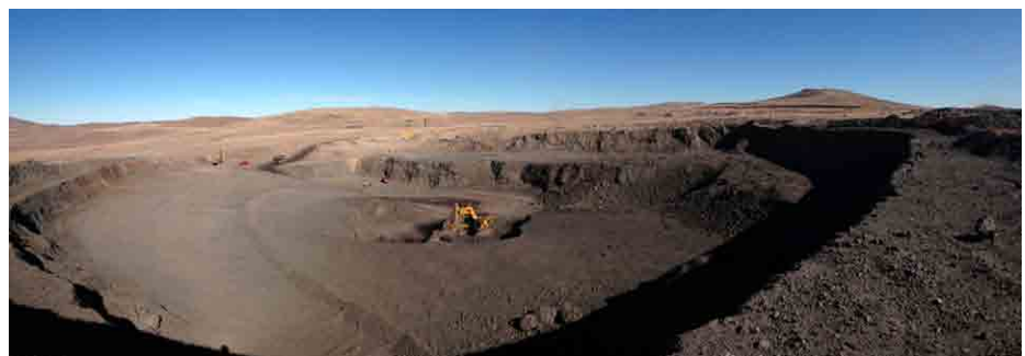
Extracción primeros bancos pit de transición BS.
